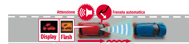
3. Applica automaticamente il freno se il rischio di collisione aumenta.
